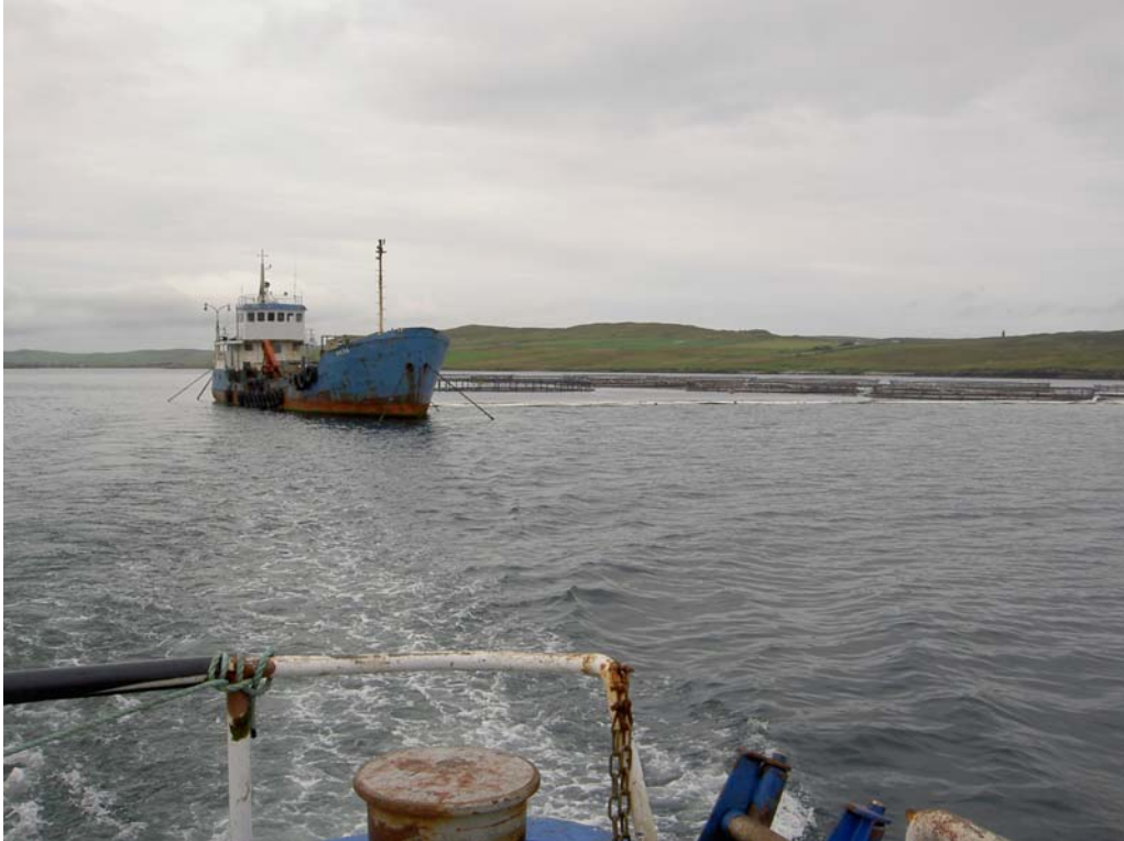
Kuva 1. Huoltoalus on ankkuroitu pysyvästi kassien läheisyyteen. Ruokinta tapahtuu kuvassa näkyviä putkia pitkin. (Shetlanti 2006) (Kuva: Olof Lerche).
